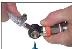
Kupplung ausschwenken - Kupplung schließt und entlüftet
