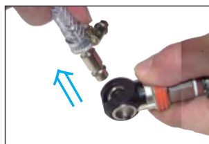
Stecker wird drucklos entnommen.
