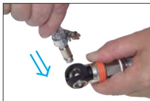
Eindrücken des Steckers in die Kupplung
